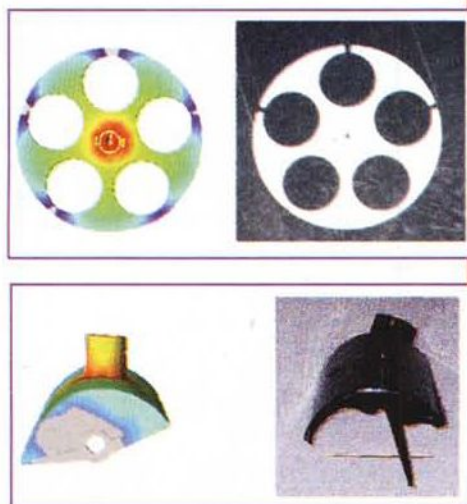
Per analizzare il grado di affidabilità dei simulatori di processo sono stati fatti confronti, in condizioni operative identiche, fra i risultati offerti dagli ambienti di virtual moulding e virtual casting e le analisi ai raggi X degli stampi reali durante il processo di iniezione. La prima figura si rifà allo stampo di un supporto di una bobina cinematografica con punto di iniezione posto nel centro. Le altre invece si riferiscono ad una pezzo di un aspirapolvere con punto di iniezione posto in basso.
